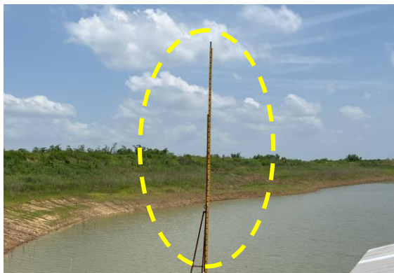
รูปที่ 58 เสาแสดงระดับน้ำในบ่อน้ำดิบและบ่อหน่วงน้ำ
