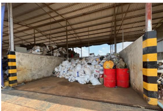
รูปที่ 73 ถังขนาด 200 ลิตร สำหรับจัดเก็บกระดาษกรองปนเปื้อนสารตะกั่วจากห้องปฏิบัติการ
