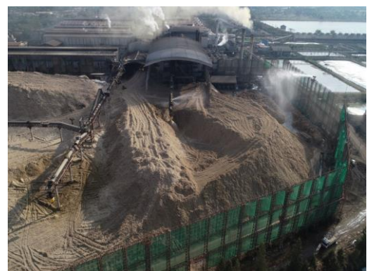
รูปที่ 18 การฉีดพรมบริเวณลานกองเก็บกากอ้อย
