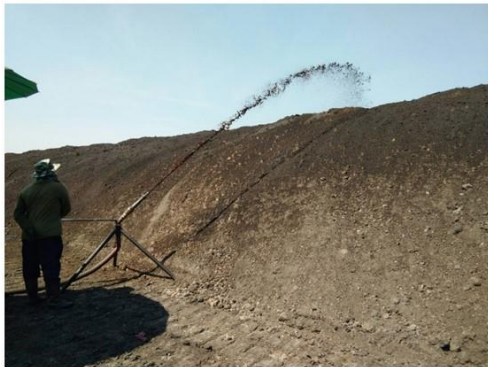
รูปที่ 27 การฉีดเชื้อจุลินทรีย์ดับกลิ่น บริเวณลานกองกากตะกอนหมักกรองและลานกองเถ้า
